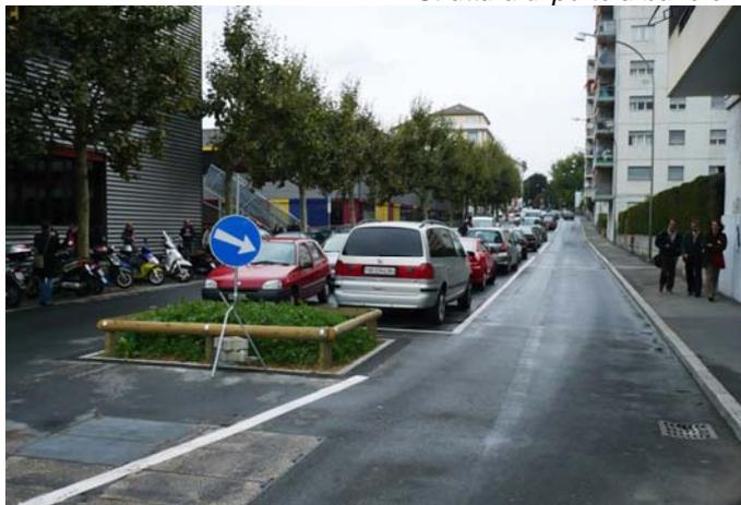
Riorganizzazione della sosta all'interno delle Zone 30: il posizionamento delle file in centro strada, piuttosto che ai lati, ha due vantaggi: incremento della capacità di sosta, in quanto non ci sono interruzioni dovute agli accessi e sfruttamento dell' "effetto ostacolo laterale", che limita le velocità; inoltre i percorsi pedonali hanno maggiore continuità e i marciapiedi possono essere abbassati, con un dislivello minimo di percezione di 1 – 2 cm.
